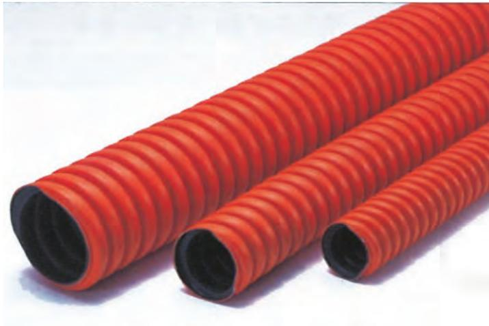
鋼板と難燃性ポリエチレンの複合構造により、圧縮強度が高く、さらに可とう性を有し、浅層埋設、道路下埋設、高圧引込み、電線共同溝等にお使い頂けます。
