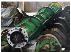
●遠心機 型枠を高速回転させ、遠心力でコンクリートの厚さを均一にして締め固め、中空に成形します。
