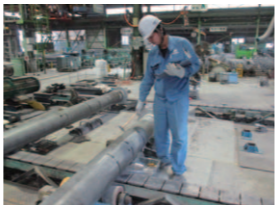
●脱型時・仕上後検査 製造されたポールを検査規格に基づき、検査を行い、不適合品は仕上後に再検査を行います。
