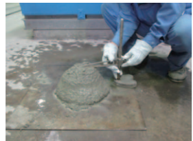
●スランプ試験 各材料がきちんと計量されたコンクリートに練られているかを試験します。
