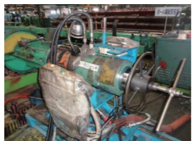
●自動緊張装置 型枠の中に入っている鉄筋籠の主鉄筋を引っ張ります。
