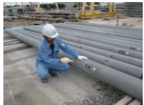
●出荷検査 出荷前に検査規格に基づき、検査を行い、合格品を出荷します。
