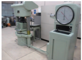
●圧縮強度試験 小型遠心機で成形された供試体を耐圧試験機(3000kN)により、強度を確認します。
