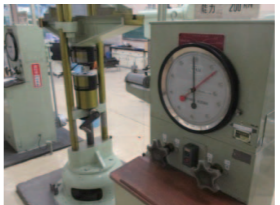
●鉄筋引張試験 鉄筋を所定の位置で固定し、万能試験機(200kN)により、引張試験を行い、強度を確認します。
