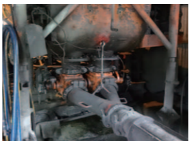
●コンクリートポンプ コンクリートを油圧シリンダーで圧送して注入管に通し、型枠に注入します。
