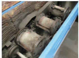
●供試体作成 コンクリートを採取し、型枠に詰め、小型遠心機により高速回転させ、製品同一の供試体を作成します。
