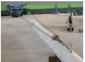
●足場ボルト取付装置強度試験 足場ボルトを引っ張り、足場取付装置の強度を確認します。
