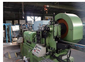
●直線切断機 コイル状で搬入された鉄筋を直線に加工し規定寸法で切断します。
