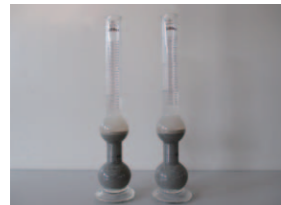
●表面水率試験 細骨材(砕砂)の表面に付着している水の割合を調べます。
