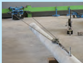
■足場ボルト取付装置強度試験 足場ボルトを引張り、足場取付装置の強度を確認します。
