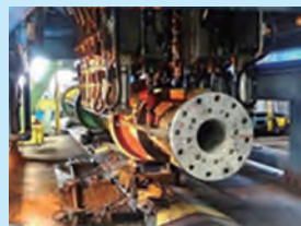
■合わせ目ボルト緩め装置 2分割(上・下)になっている型枠の連結しているボルトを自動で緩めます。
