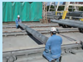
■構造試験 コンクリートポールの直径、長さ、足場ボルトのピッチ等測定し、合否判定をします。
