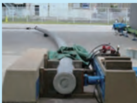
■ポール曲げ強度試験 ポールの性能がJIS規格、お客さまの要求事項を満たしているか破壊強度を確認します。
