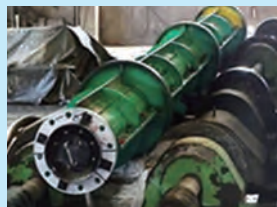
■遠心機 型枠を高速回転させ、遠心力でコンクリートの厚さを均一にして締固め、中空に成形します。
